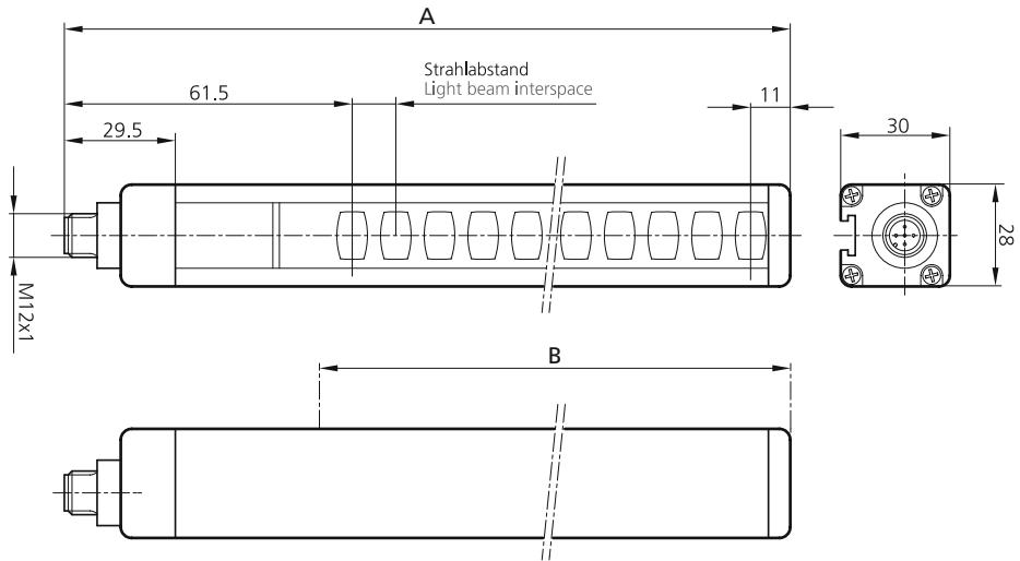
Sicherheitslichtgitter - Ausführung Standard / Slave / Safety light grids - Version Standard / Slave
