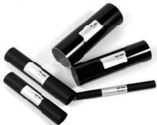
Der **Prüfstab** ist ein Zylinder aus Aluminium mit matter Oberfläche, der nach der Installation der Sicherheitslichtvorhänge verwendet wird, um sicherzustellen, dass kein Strahl aufgrund reflektierender Oberflächen umgelenkt wird. Die Prüfung erfolgt durch langsames Bewegen des Teststabes ( $\varnothing$  = Auflösung) in der Mitte und entlang jeder Seite des Überwachungsbereiches. Während der Prüfung muss die grüne LED des Empfängers permanent aus sein.
