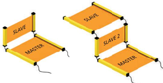
Es ist möglich, jedes Master-Modell mit jedem beliebigen Slave-Modell zu verbinden. Alle elektrischen Anschlüsse sind mit 5-poligen M12-Steckern ausgeführt, mit Ausnahme des Master-Empfängers, der einen 8-poligen M12-Stecker benötigt.
