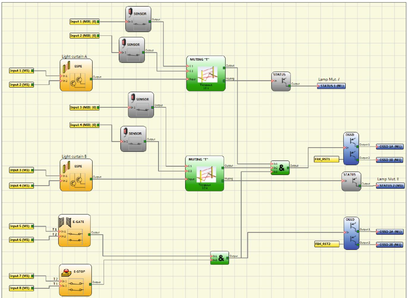
**Hinweis:** Die RESET-Tasten sind nicht im Diagramm angezeigt, da sie direkt mit dem "Feedback" der OSSD Safety Ausgänge verbunden sind (Inputs FBK\_RST1, FBK\_RST2). Die 3 E-Stopps sind reihengeschaltet und im Diagramm durch einen einzelnen Eingangs-Baustein dargestellt. Das Diagramm zeigt ebenfalls den Status der 2 Ausgänge an, die zum Betreiben der Anzeigeleuchten des aktiven Mutings benötigt werden.
