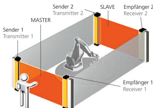
Bei den Sicherheitslichtvorhängen /-gittern SLI wird für die Verbindung zwischen Master und Slave ein (nicht abgeschirmtes) Standardkabel verwendet, das eine Länge von bis zu 50 Metern haben kann (siehe Seite 64).
