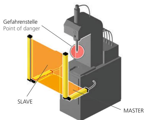
Der Master ist für die Erkennung des Körpers horizontal positioniert, während der vertikale Slave die Erkennung der Hände übernimmt.
