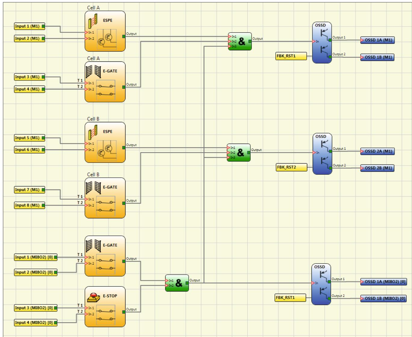
**Hinweis:** Die RESET-Tasten sind nicht im Diagramm angezeigt, da sie direkt mit dem "Feedback" der OSSD Safety Ausgänge verbunden sind (Inputs FBK\_RST1, FBK\_RST2). Die 4 E-Stops sind reihengeschaltet und im Diagramm durch einen einzelnen Eingangs-Baustein dargestellt.
