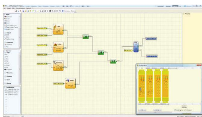
Der **Safety Designer MS-SD** ist eine benutzerfreundliche Konfigurationssoftware, die die Programmierung von **MODSI** in einigen wenigen Schritten ermöglicht.
