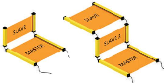
Es ist möglich, jedes Master-Modell mit jedem beliebigen Slave-Modell zu verbinden. Alle elektrischen Anschlüsse sind mit 5-poligen M12-Steckern ausgeführt, mit Ausnahme des Master-Empfängers, der einen 8-poligen M12-Stecker benötigt.
